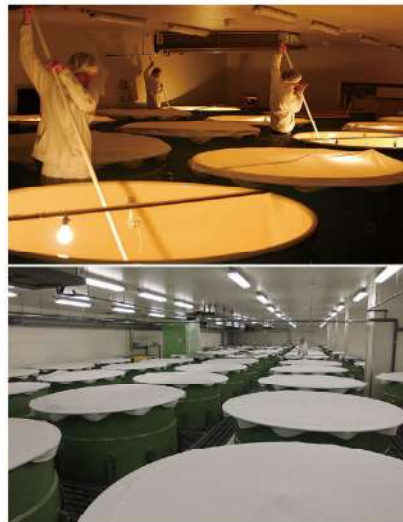
発酵中の酒は年間通して6度に温度を保ち、0.1度刻みで管理する。停電によりコントロールが効かなくなったことで、タンク150本がダメージを受けた
